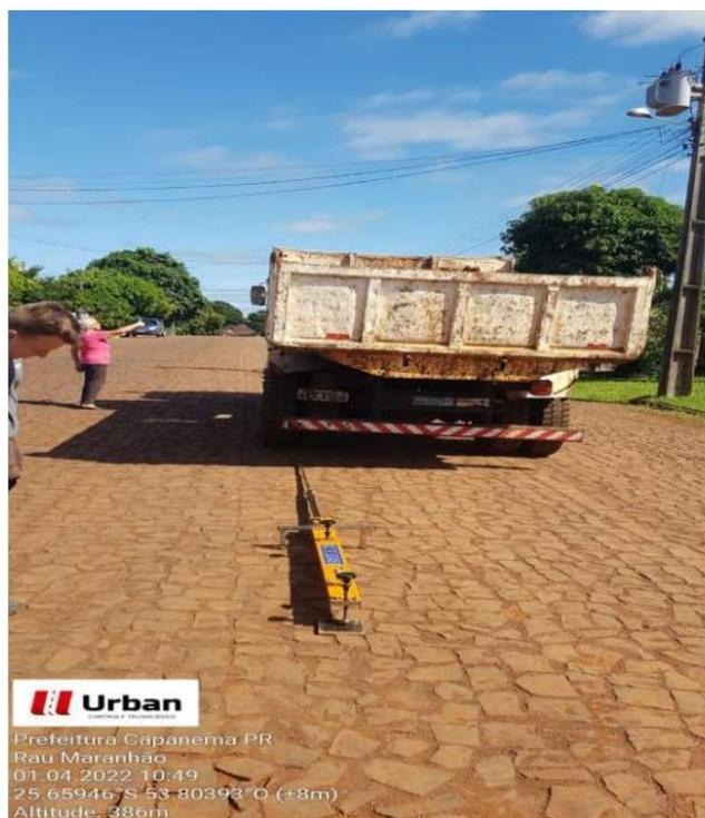
O ensaio de viga Benkelman foi efetuado atendendo as normas DNER-ME 24/94 – Pavimento – Determinação das deflexões pela viga Benkelman; DNER-PRO 175/94 – Aferição de viga Benkelman e DNER-ME 061/94 – Pavimento – Delineamento da linha de influência longitudinal da bacia de deformação por intermédio da viga Benkelman.
